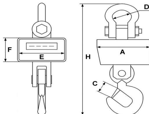
Все крановые весы, поставляемые компанией ПетВес, проходят настройку метрологических параметров и калибровку по той географической широте, где планируется использование весов при помощи лицензированной по ГОСТ Р 8.663-2009 эталонной силовоспроизводящей установки 1-го разряда серии СМ.
